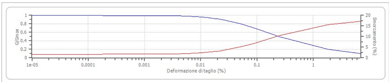
Figura 37 – Curve derivate da prove su campione estratto nel Comune di Tolentino (MC) per litotipo CLtf.
