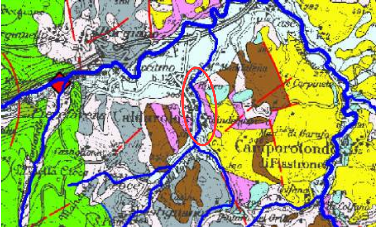
Figura 19 - Stralcio delle Schema idrologico della Regione Marche (2002). Nel cerchio, in rosso, l'area oggetto di studio. Il "celestese" indica il Complesso idrogeologico delle pianure alluvionali e dei depositi fluvio-lacustri e lacustri (Olocene - Pleistocene superiore e medio).
