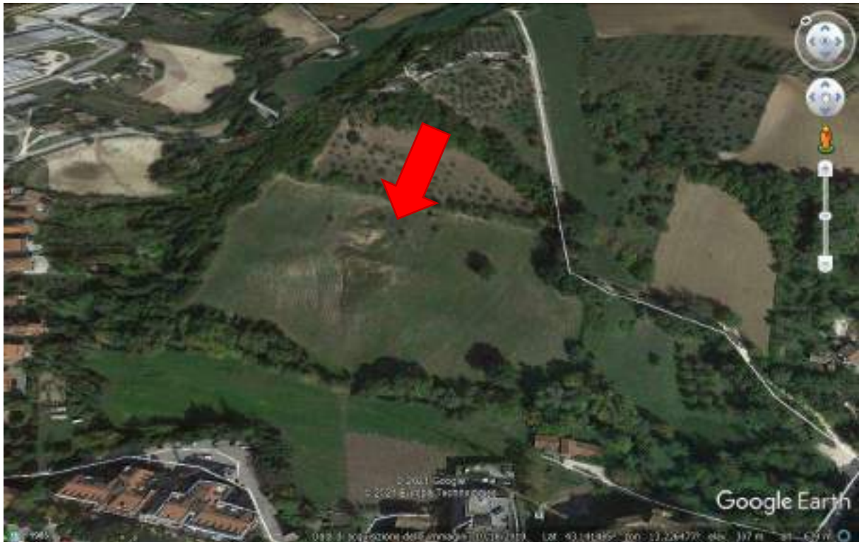
Foto 1 – Corpo di frana per scorrimento roto/traslattivo presente nel versante occidentale di Colle Antico, in destra idrografica del Fosso delle Conce.
